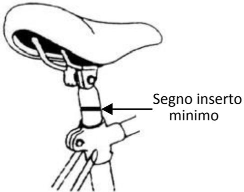
Per regolare l'altezza della sella, introdurre il tubo reggisella nel tubo del telaio. Quando la sella è posizionata all'altezza desiderata, stringere la leva o la vite di fissaggio.
